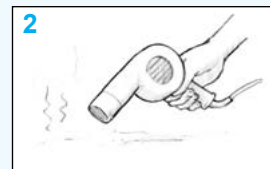
Figur 7 Torka ytan. Låt ytan torka helt eller påskynda torkning med hjälp av värmepistol eller fläkt.
