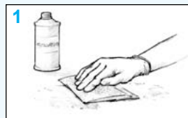
Figur 6 Rengör ytan. Använd vid behov acetone alt. WEST SYSTEM 850 för att avlägsna föroreningar.
