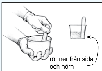
Figur 3 Blanda bas och härdare noga i 2 minuter – längre tid i lägre temperaturer.
