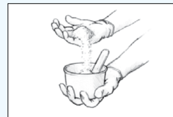
Figur 4 Tillsätt små mängder fyllnadsmedel i taget till önskad konsistens.
